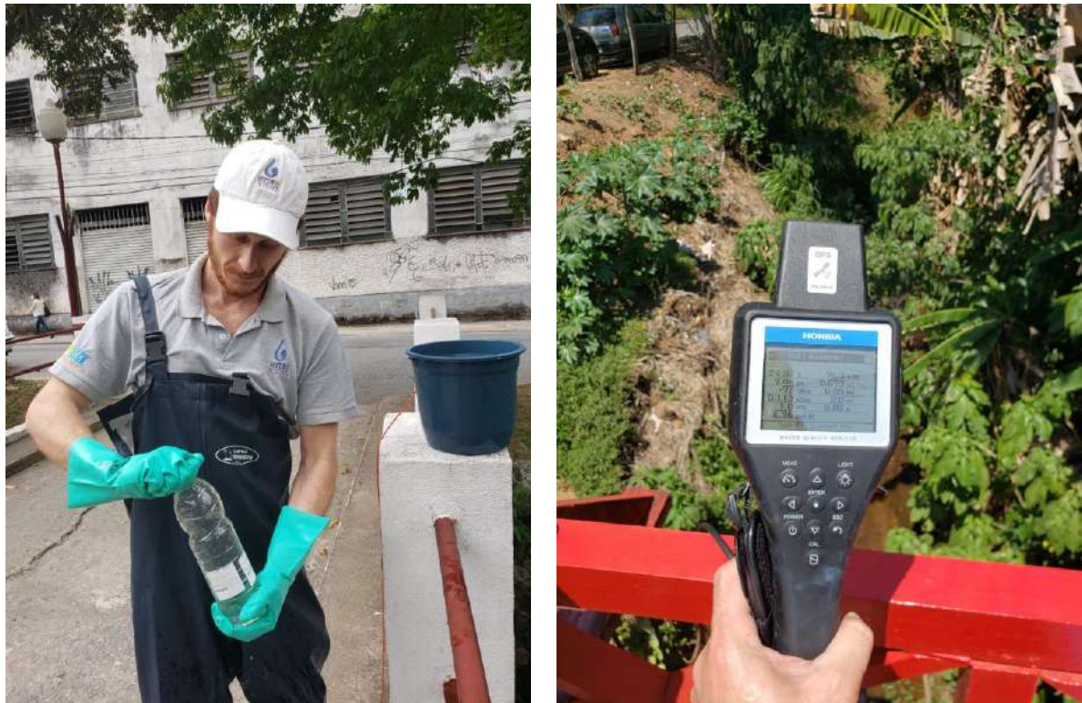
Figura 3. Coleta de água para análise laboratorial e sonda multiparâmetros para Monitoramento de rios da Região Hidrográfica Piabanha (RH-IV).
