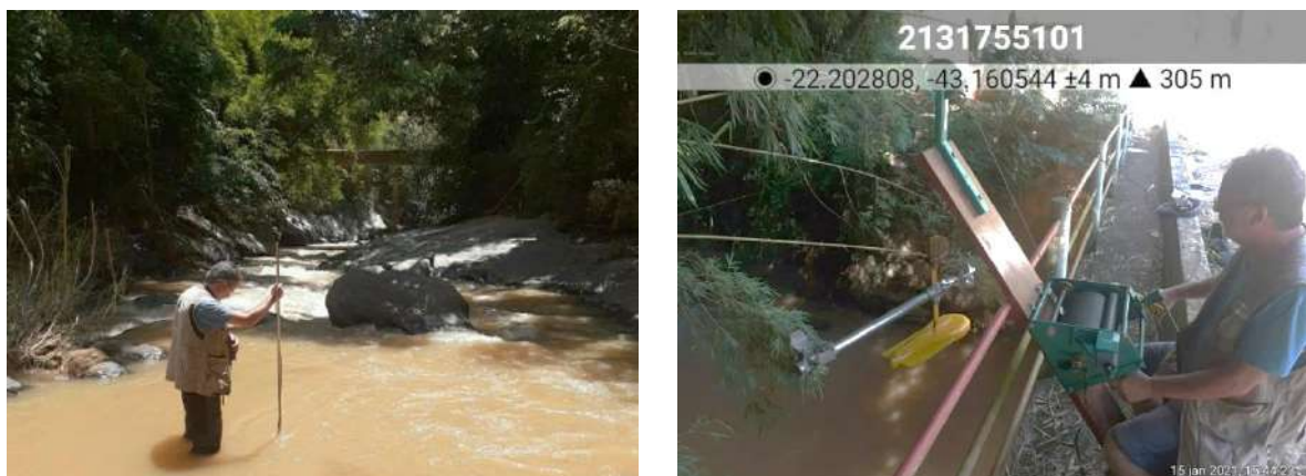
Figura 6. Medições de fluxo com molinete operado em haste a vau (esq.) e operado com guincho fluviométrico e lastro (dir.).
